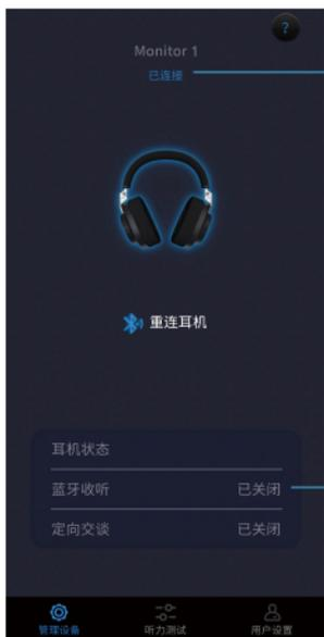
耳机与手机完成配对后, 此处显示耳机已连接, 如显示未连接, 可点击重连耳机进入蓝牙搜索页面
